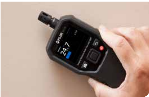
采用无探针测量模式验证湿气问题
